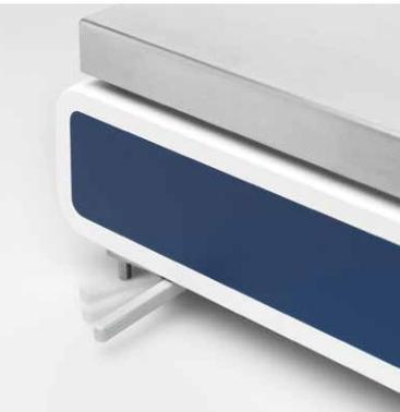
Фиксируемые задние опоры **LevelLock** обеспечивают дополнительную надежность стабилизации, предотвращая крен весов при эксцентрической нагрузке (для моделей с дискретностью 0,01 г).
