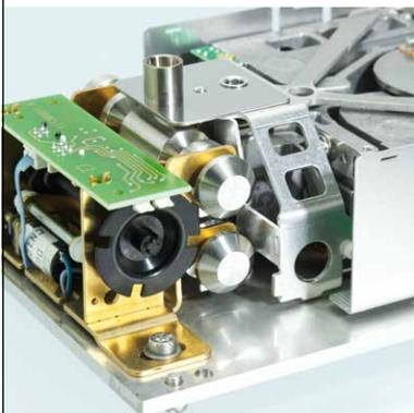
Датчик веса METTLER TOLEDO HRT (HiRes Technology) содержит две встроенные калибровочные гири. Совместно с автоматической системой калибровки FACT это позволяет весам автоматически выполнять процедуры регулировки и линеаризации.
