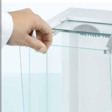
Очистка весов никогда еще не была таким простым делом: несколькими движениями откройте фиксаторы QuickLock и снимите стеклянные панели защитного кожуха и каплесборник, затем вымойте их в посудомоечной машине.
