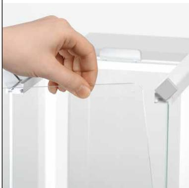
Снять, вымыть и установить на место все стеклянные панели защитного кожуха **QuickLock** можно несколькими простыми движениями – без использования инструментов и не перемещая весы.
