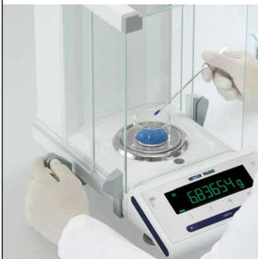
Каждая операция взвешивания требует минимального количества движений. Дверцы защитного кожуха ErgoDoor открываются одной рукой, при этом второй рукой можно одновременно поместить взвешиваемый образец на чашу весов.
